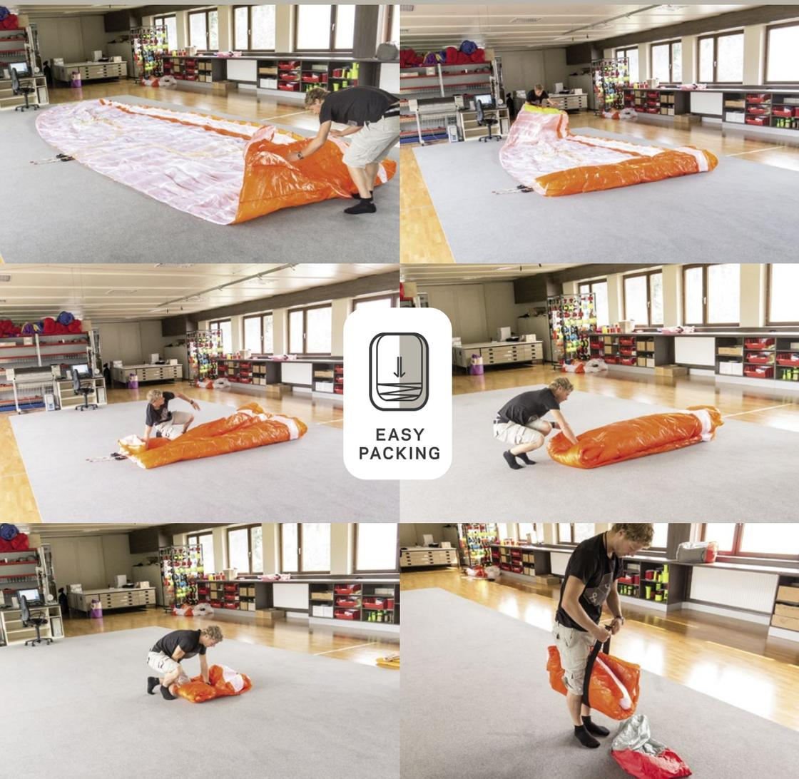
Nous conseillons de plier votre parapente de manière classique; aligner les cellules au bord d'attaque puis le reste de la voile cellule par cellule ensuite plier la voile en accordéon plutôt que de la rouler. Cela améliorera le confort au portage. Veillez à éviter de plier les joncs du bord d'attaque. Cette méthode simple de pliage est rendue possible grâce au choix des matériaux utilisés.
